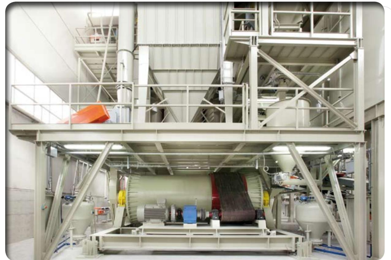
Impianto MICROTON per la macinazione di silicato di zirconio, allumina, sabbie quarzifere, carbonato di calcio, feldspato, nefelina, ossido di zirconio, magnesite, bentonite.
