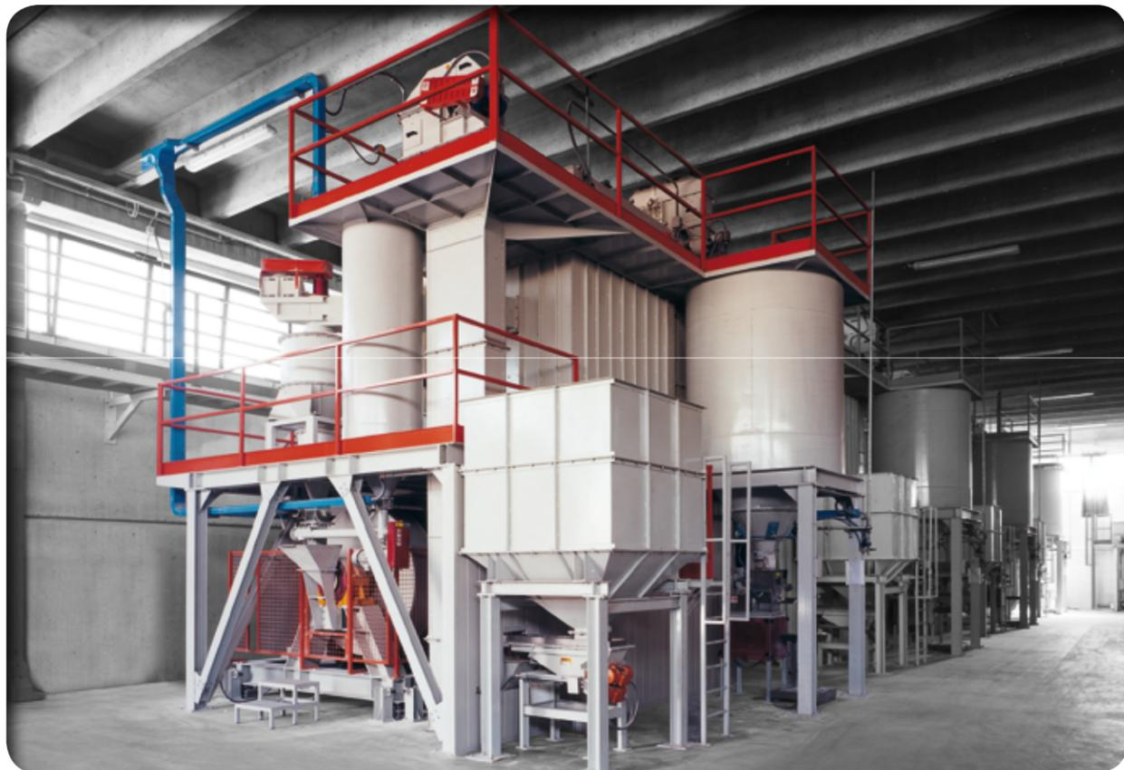
Impianto MICROTON per la macinazione di silicato di zirconio, feldspato, dolomite, wollastonite, ossido di zirconio, bakelite.
